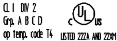
Abb. 3.1.2-4: Bedruckungstext Detail gemäß CENELEC and IEC
